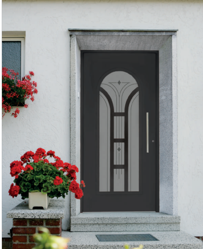
R 1111 flügelüberdeckend Ornamentrahmen nur außen umlaufend Farbe: ST 703 dunkelgrau Glastype: 1111.7311 Klarglas teilmattiert Linien und Rauten klar Griff: 0101 E-60
